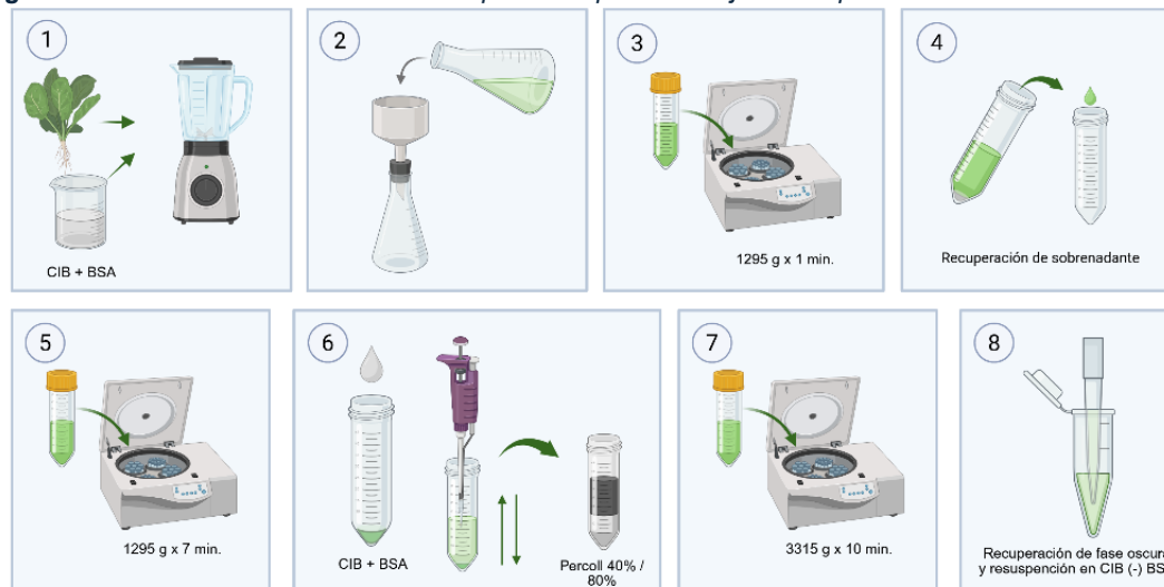
Figura 7. Protocolo de extracción de cloroplastos a partir de hojas de espinaca. Creado con BioRender.
