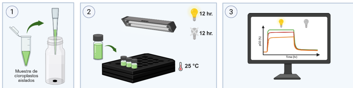
Figura 8. Diagrama general del uso del sistema PreSens SDR para la medición de la liberación de oxígeno en cloroplastos aislados. Creado con BioRender.
