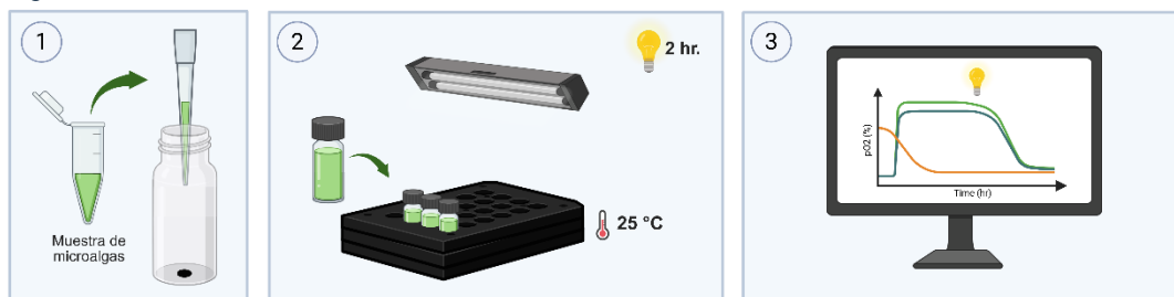
Figura 10. Diagrama general del uso del sistema PreSens SDR para la medición de la liberación de oxígeno en microalgas. Creado con BioRender.
