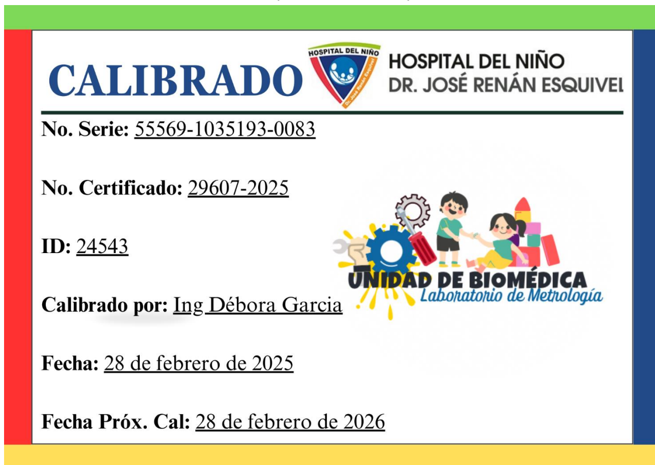
Fig25. Modelo de sticker de calibración, debe ser colocado en los equipos médicos luego de ser calibrado.
