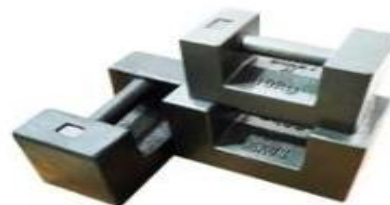
Fig12. Pesas paralelepípedos con eje o agarradero para mejorar la sujeción.
