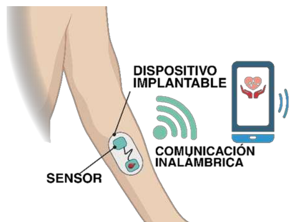
Figura No. 1 Dispositivo implantable con conectividad inalámbrica para el monitoreo de parámetros fisiológicos a distancia.
