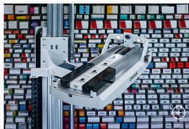
El diseño del manipulador le permite manejar múltiples productos de dimensiones similares al mismo tiempo.
