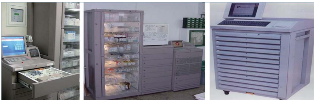
Ilustración 30. Diferentes estaciones dispensadoras-automatizadas periféricas. Fuente: Google Photos.
