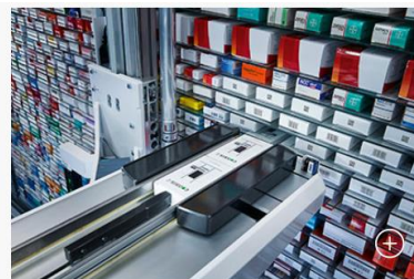
Una vez que el manipulador ha retirado las cajas de la cinta de carga, las coloca siempre de tal forma que la primera caja de una serie queda junto al borde delantero del estante.
